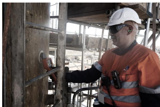
现场工作人员可以轻松获取厚度读数，而无需每次都对表面进行打磨处理
